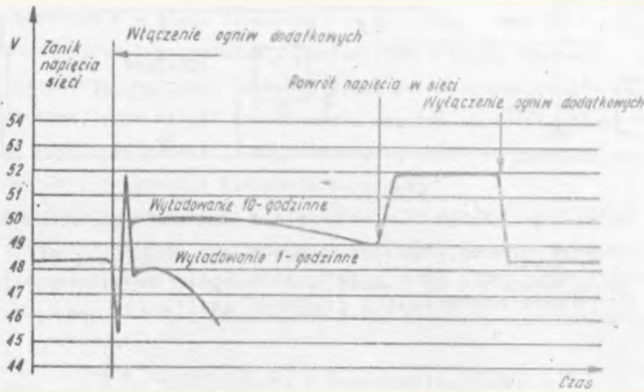
Rys. 12. Rozkład napięcia w siłowni z baterią 22+3 ogniwa przy dużym obciążeniu
