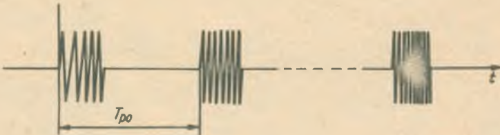
Rys. 10. Przebieg prądu w.cz. na wyjściu nadajnika
