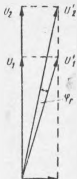
Rys. 15. Wpływ nieliniowości charakterystyki wzmacniacza i sygnału pasożytniczego podnośnej chrominancji na fazę różnicową
