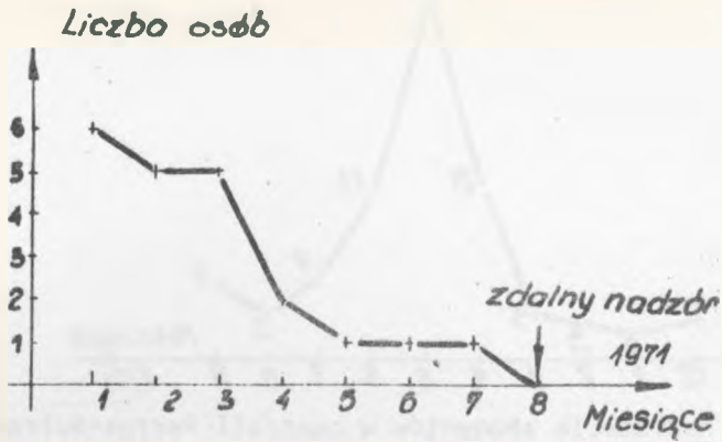
Rys. 12. Liczba osób personelu w centrali Perros-Guirec w poszczególnych miesiącach po oddaniu centrali do eksploatacji
