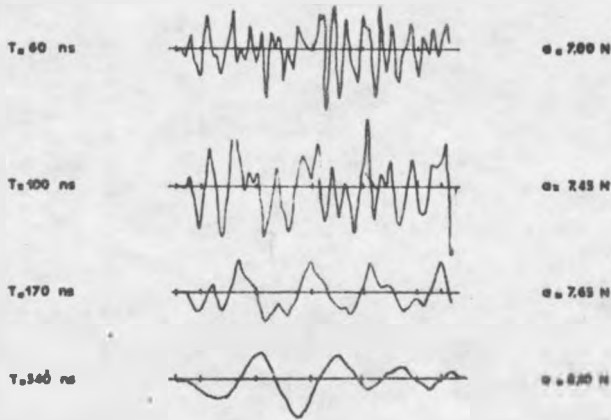
Rys. 1. Krzywe odpowiedzi impulsowych o skorygowanej amplitudzie i fazie dla przeniku zbliżonego, między dwiema parami
