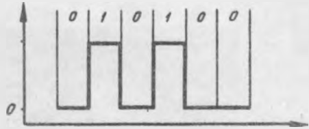
Rys. 3.1. Liczba 20 przedstawiona za pomocą kodu 6-bitowego
