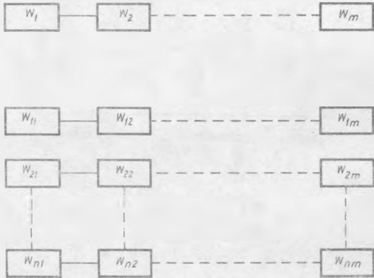
5.1. Układ czwórników nieliniarnych połączonych łańcuchowo (a) i układ zastępczy złożony z czwórników linearnych (b)
