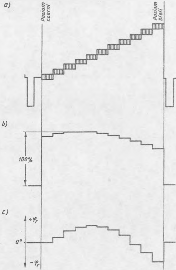
5.2. Pomiar zniekształceń różnicowych za pomocą schodkowego sygnału pomiarowego z nakładką podnośnej chrominancji: a) sygnał pomiarowy, b) przykładowy przebieg wzmacnienia różnicowego, c) przykładowy przebieg fazy różnicowej
