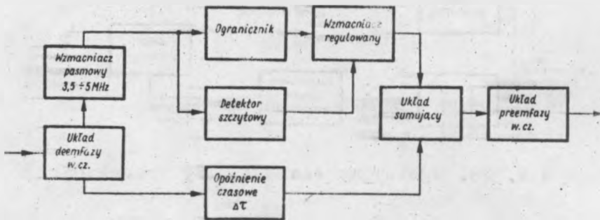
Rys. 32. Układ do wydzielania sygnału luminancji
