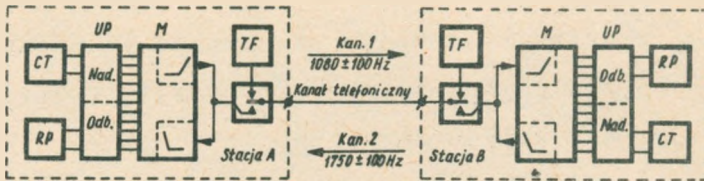
Rys. 11. Zasada transmisji w systemie THG 1020
