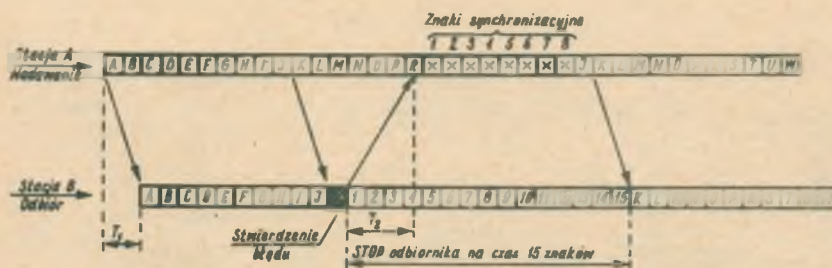
Rys. 21. Zasada powtarzania błędnych informacji w systemie TD 1200
