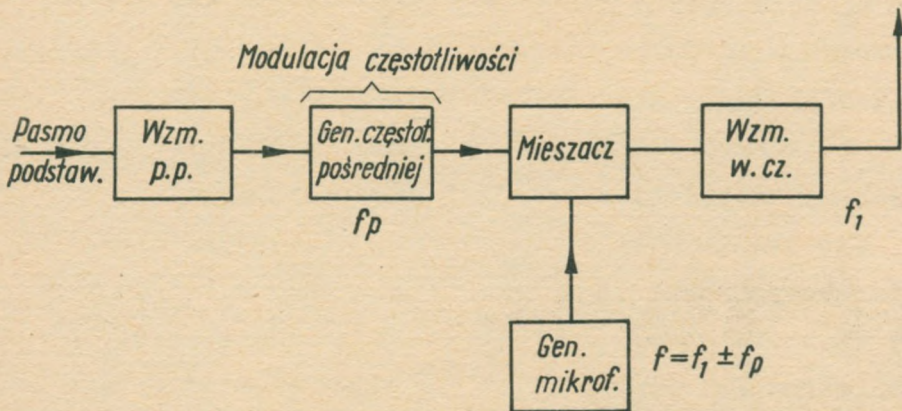
Rys. 8. Dwie zasadnicze metody modulacji częstotliwości fali nośnej nadajnika mikrofalowego
