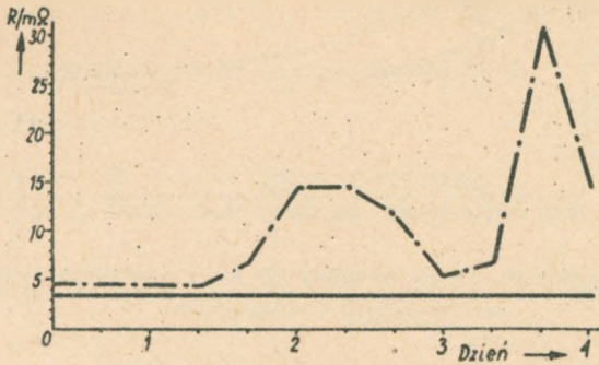
Rys. 8. Zmiany oporności złączy tył wykonanych metodą skręcania /---/ i metodą mechanicznie ściśniętego łącznika /—/ wg P. Lancisera [10]
