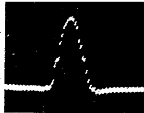
Rys. 6. Oscylogram impulsu sinus-kwadrat sfotografowanego z ekranu wąskopasmowego oscylografu /HO - 1/
