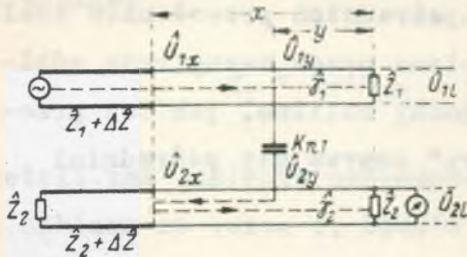
Rys. 3. Przesłuch zdalny występujący na skutek odbić w torze zakłócanym
