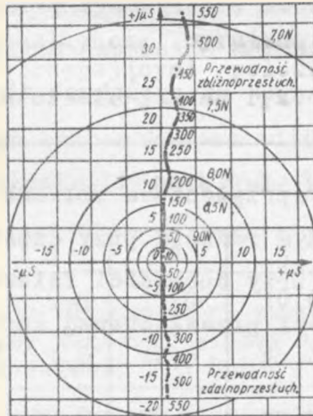
Rys. 20. Przewodności zbliżno i zdalno-przesłuchowe wytworzone przez transformator z rdzeniem wykreślonym
