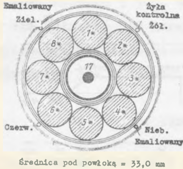
Rys. 1. Profil kabla typu 17a /17 # ÷ 8 # czwórki gwiazdowe 1,3 mm Cu, 17 - para współosiowa 2,6/9,5 mm Cu/
