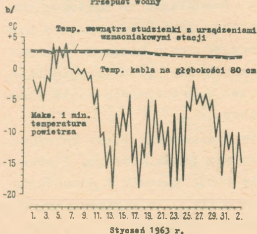
Rys. 20. Podziemna stacja wzmacniakowa: a) przekrój przez studzienkę kablową, b) wykres temperatur w styczniu 1963 r.
