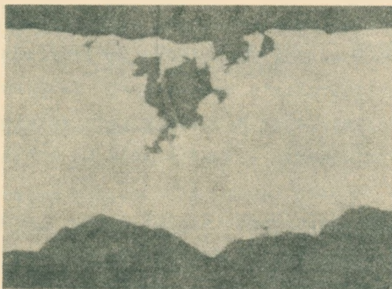
Rys. 1. Tak zwana korozja fenolowa. Uszkodzenia idące w głąb metalu. Kawerny wewnątrz metalu połączone bardzo cienkimi kanalikami z wżerami na powierzchni. Wewnętrzna część powłoki ołowianej /u dołu fotografii/ posiada uszkodzenia typowe dla korozji elektrolitycznej. /Przekrój mikrotomowy przez miejsce wżeru na powłoce ołowianej kabla. Powiększenie 40-krotne/.
