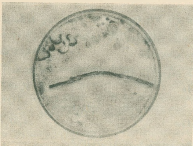
Rys. 4. Próbką juty, nasyconej 5-procentowym roztworem pięciochlorofenolu, ułożona na pożywce zaszczipionej mikroflorą glebową. Na rysunku widoczna wyraźna strefa ochronna po obu stronach sznurka. W strefie tej nie wystają kolonie mikroorganizmów
