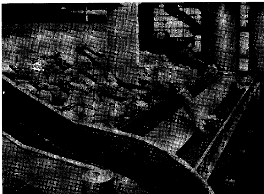
Rys. 12. System składowania worków w rozdzielni paczkowej i wyładowywanie paczek na taśmę przenośnika
