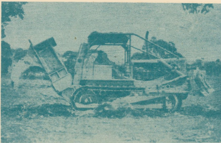
Rys. 11. Wygląd zewnętrzny spychacza typu HD 16 na gąsienicach z czterostopowym pługiem - rozrywaczem
