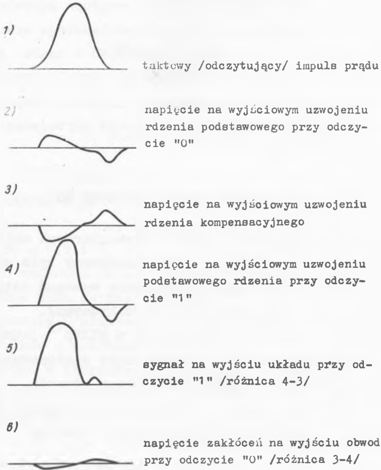
Rys. 1. Obwód i wykresy impulsów wyjaśniające kompensację "zer"
