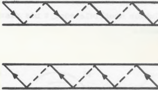
Rys.6. Dwa stany magnesowania twistora
