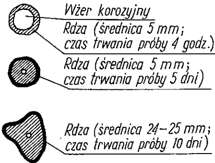
Rys.8. Schemat rozkładu korozji na powierzchni próbki znajdującej się w kontakcie ze szklanymi kuleczkami pokrytymi warstwą wody
