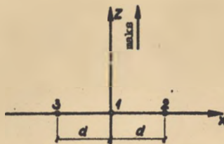
Kys. 7. Układ antenowy slotowy z trzech źródeł isotropowych
