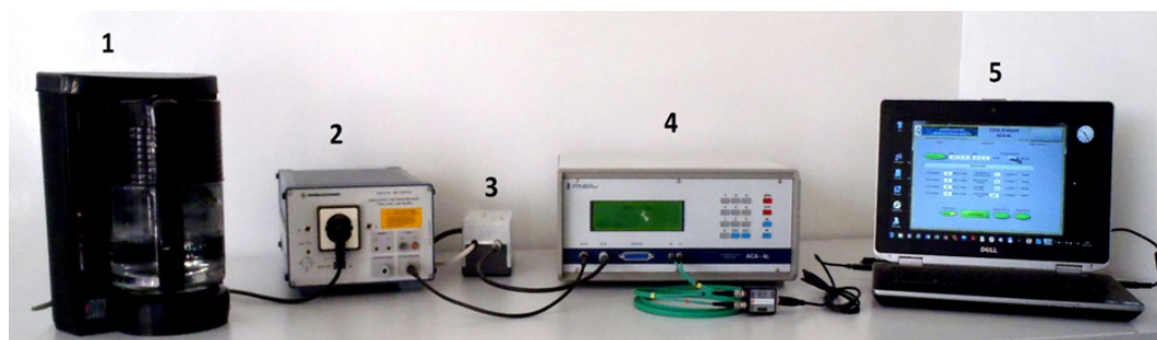
Rys. 5. Widok analizatora ACA-4c na stanowisku pomiarowym: 1 – badany obiekt, 2 – sieć sztuczna, 3 – czujnik przełącznic ACA-SS, 4 – analizator ACA-4c, 5 – komputer z oprogramowaniem
