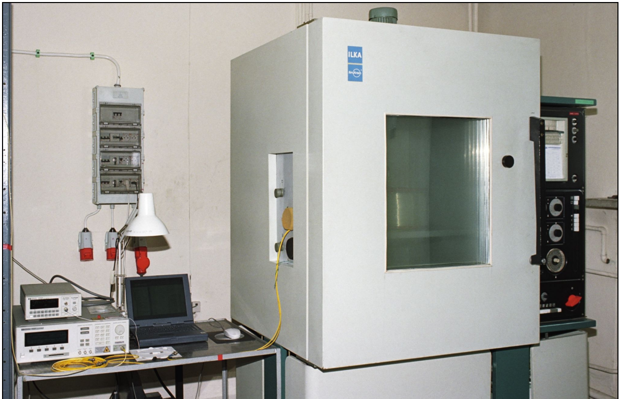
Rys. 107. Badanie termiczne włókna światłowodowego OTO-3 na szpuli w komorze Feutron KPK.
