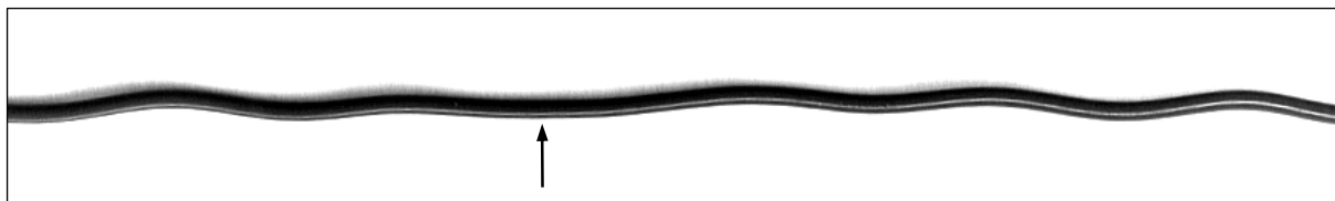
Rys. 78. Włókno w pokryciu ścisłym \varnothing 0,9 mm odkształcone w spiralę rewersyjną. Obraz skrócony w osi poziomej w stosunku 1:4. Parametry skrętu: p \approx 8 mm, d \approx 1 mm. Strzałka pokazuje miejsce odwrócenia kierunku skrętu.
