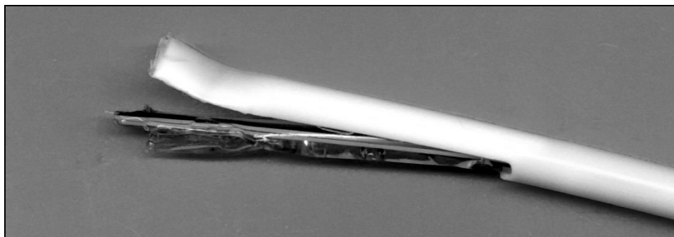
Rys. 15. Uszkodzenie tuby w wyniku hydrolizy PBT tworzącego warstwę zewnętrzną.
