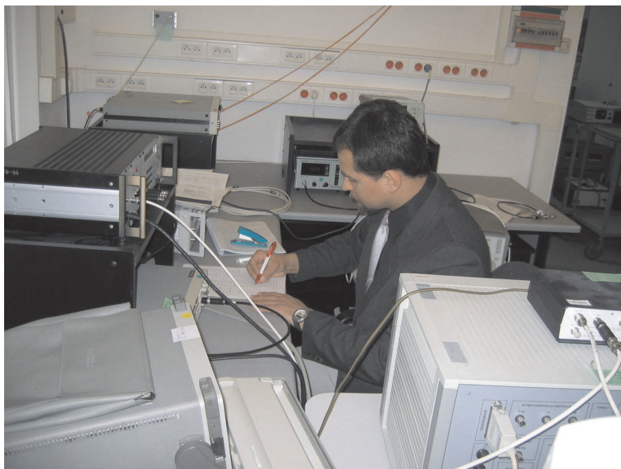
Rys. 12. Stanowisko kalibracyjne do wzorcowania urządzeń PDH/SDH w Laboratorium Metrologii Elektrycznej, Elektronicznej i Optoelektronicznej
