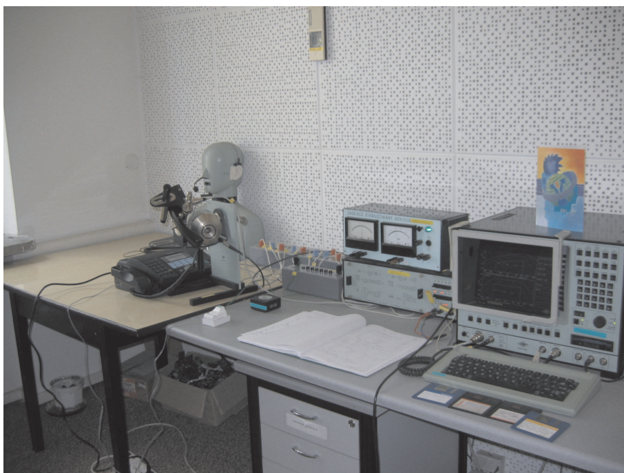
Rys. 11. Zestaw do obiektywnych pomiarów telefonometrycznych urządzeń końcowych, z wykorzystaniem sztucznej głowy, w Laboratorium Badań Urządzeń Telekomunikacyjnych (Laboratorium Badań Telekomunikacyjnych Urządzeń Końcowych L4)
