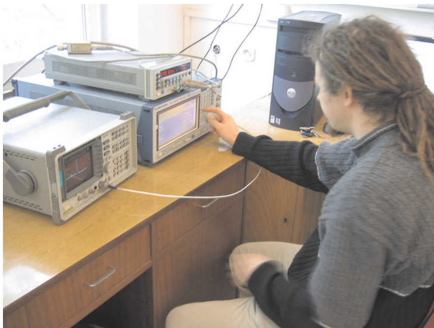
Rys. 9. Stanowisko pomiarowe do wzorcowania generatorów w.cz. w Laboratorium Metrologii Elektrycznej, Elektronicznej i Optoelektronicznej
