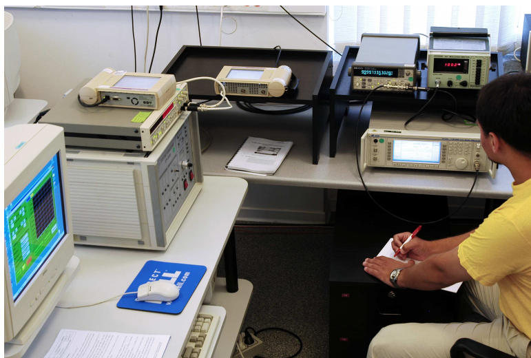
Rys. 4. Stanowisko do wzorcowania częstościomierzy
