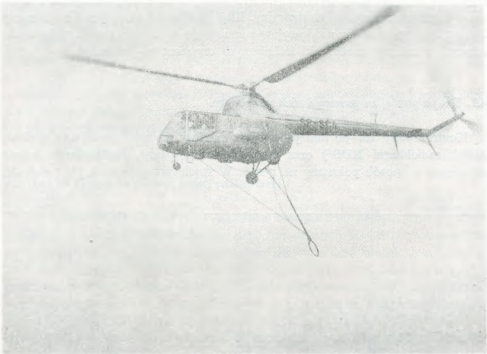
Rys. 7. Ustawianie anteny pomocniczej w pozycji pomiarowej
