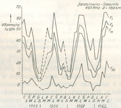
Rys. 2. Przebieg wartości natężenia pola F(50) , F(10) , F(5) , i F(1) na trasie Jarosławiec-Sassnitz w całym okresie sprawozdawczym
