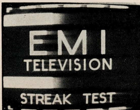
Rys. 15. Fotografia testu kontrolnego przy zbyt małej korekcji poświaty
