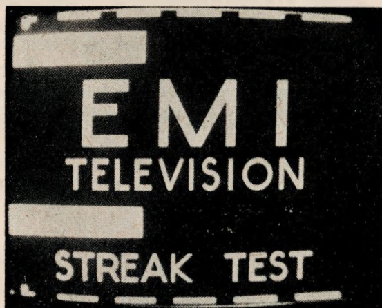
Rys. 16. Fotografia testu kontrolnego przy właściwej korekcji poświaty
