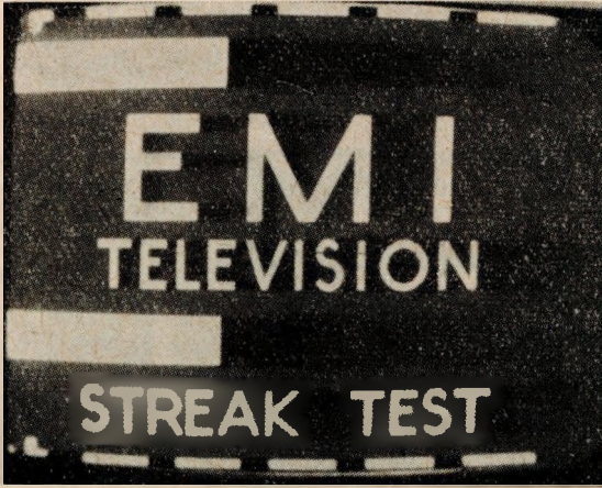
Rys. 17. Fotografia testu kontrolnego przy nadmiernej korekcji poświaty
