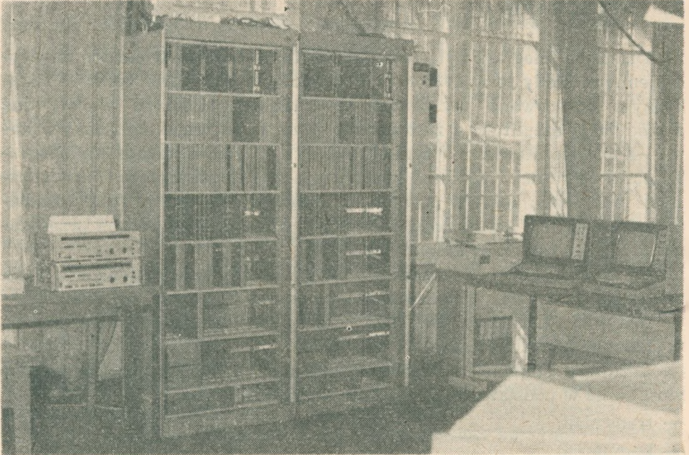
Rys. 14. Model użytkowy elektronicznej centrali telegraficzno-teleinformatycznej ECTT
