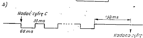
Rys. 4. Diagram stanów procesu nadawania serii impulsów wybierczych (a) oraz sekwencja stanów pętli sterowanej wg tego diagramu (b)
