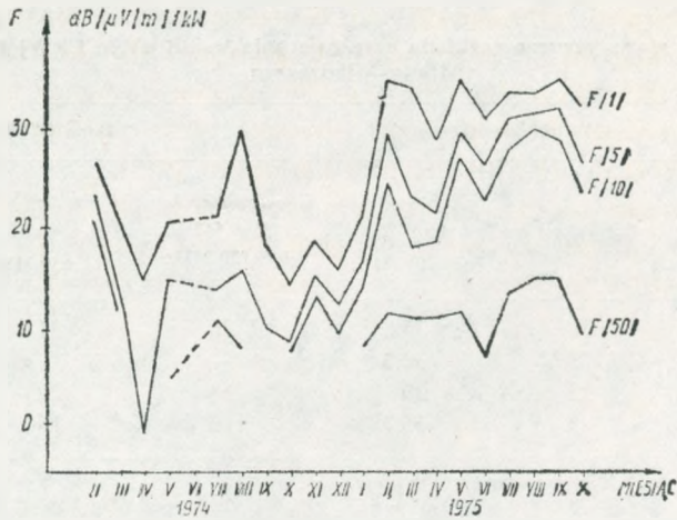
Rys. 5. Wartości natężenia pola przekraczane w 50%, 10%, 5% i 1% czasu w stosunku miesięcznym dla trasy Mława-Miedzeszyn
