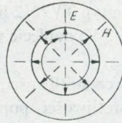
Rys. 5. Linie pola elektromagnetycznego fali modu H_{01} w falowodzie
