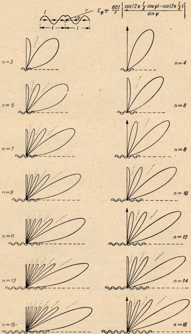
Rys. 5. Charakterystyki ćwiartkowe promieniowania symetrycznego wibratora prostoliniowego w wolnej przestrzeni
