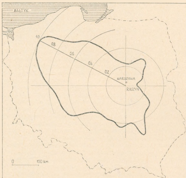
Rys. 1. Charakterystyka promieniowania w płaszczyźnie poziomej, jaką powinna mieć radiostacja w Raszynie aby zapewnić stałą wartość natężenia pola na granicach Polski
