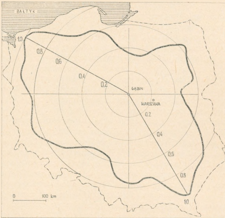
Rys. 2. Charakterystyka promieniowania w płaszczyźnie poziomej, jaką powinna mieć radiostacja w Gąbinie aby zapewnić stałą wartość natężenia pola na granicach Polski
